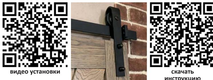
Направляющая крепится к стене. Ролики устанавливаются на полотно, и дверь навешивается на направляющую. На полу устанавливается флажок, на направляющей закрепляются стопоры и доводчики.
