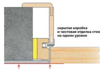
Проем должен иметь четкие размеры, не иметь сужений. Верхняя часть проема должна располагаться горизонтально и параллельно полу. Боковые стороны проема должны быть строго вертикальными и параллельными. Короб монтируется ДО проведения финишной отделки стен. Зазор между полотном и коробкой должен составлять 3 мм со всех сторон.
