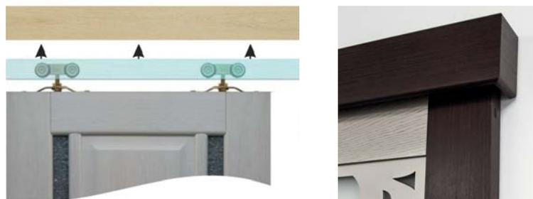
Деревянный брус крепится к стене. Снизу к брусу крепится направляющая. На полотно устанавливаются ролики. Конструкция закрывается добором 100 мм с 3-х сторон.
